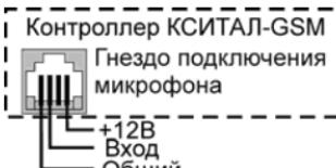
При необходимости к входу этого микрофона может быть подключен ещё микрофон "Кситал-МК". В такой цепочке допускается соединять до 3 шт. микрофонов "Кситал-МК", которые будут работать одновременно.
