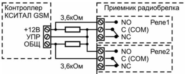
Напряжение на входе "Управление" (если это разрешено в настройке **Upравление** на SIM-карте) однозначно определяет режим (0В - на контролле, +12В - контроль снят, +6В - пассивное состояние входа).
