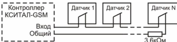
Датчики, имеющие выход типа "нормально разомкнутый сухой контакт" или "открытый коллектор" соединяются параллельно друг с другом и с добавочным резистором.
